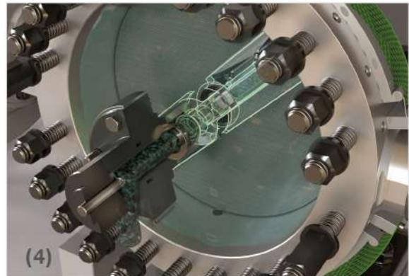
(4) Tutte le impurità vengono raccolte all'interno del raschiatore ed espulse attraverso la valvola di scarico in modo automatico.
